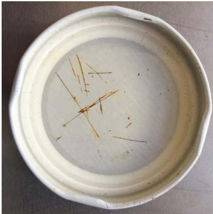
Esta tampa, devido aos pequenos sinais de ferrugem na parte interna, precisa ser descartada. Se for reutilizada, a acidez do produto irá acelerar o processo de ferrugem e o produto irá ficar com gosto metálico, ter a cor alterada e, em casos mais avançados, a ferrugem pode romper a tampa, deteriorando o produto imediatamente.
