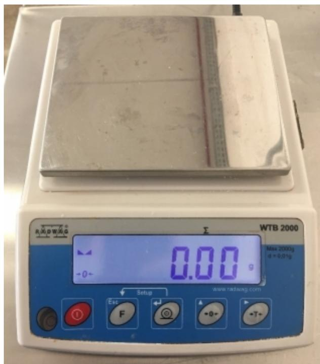
Para fazer a pesagem de qualquer ingrediente, precisa ser descontado a embalagem onde o mesmo será pesado, por isso a balança precisa ser tarada (zerada) com a embalagem vazia. Coloca-se a embalagem na balança e depois se zera, como mostram as duas fotos abaixo:
