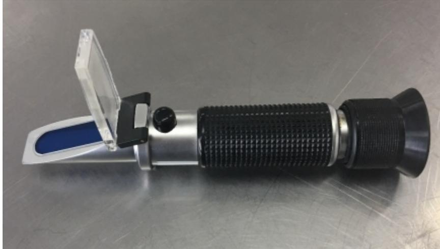
O seu funcionamento é bastante simples. Na parte da frente (chamado prisma) pinga-se algumas gotas da calda cuja concentração de açúcar se deseja medir e fecha-se a tampa. Toma-se o cuidado de não deixar bolhas de ar.
