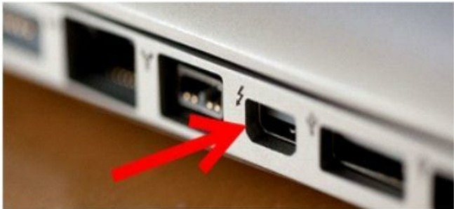
Figura 2.103 – Porta Thunderbolt (a mesma da saída Minidisplay Port).
