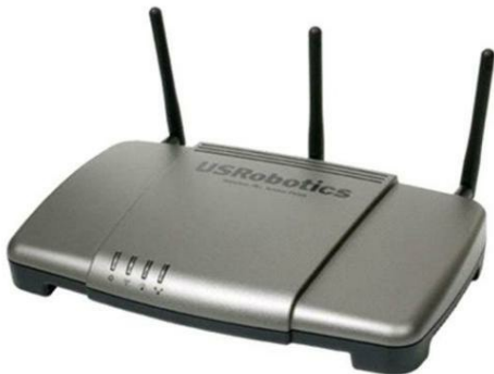
Figura 8.55 – Ponto de Acesso Wi-Fi (já com MIMO) da USRobotics®.
