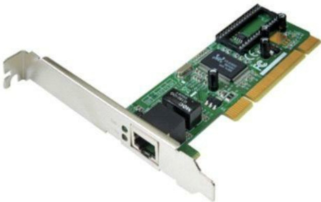
Figura 2.77 – Placa de rede Ethernet (interna ao gabinete).
