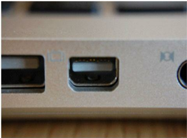
Figura 2.82 – Conector Mini Display Port, em computador Apple®.
