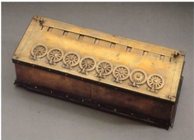
Figura 1.2 – Pascaline, uma calculadora mecânica criada por Pascal.
