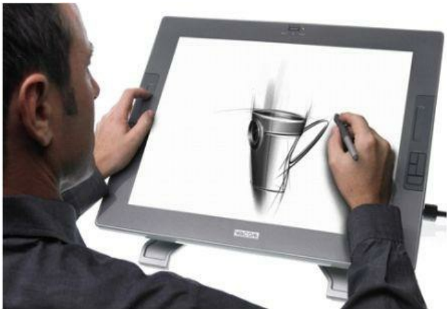
Figura 2.65 – Tablet Cintiq® da Wacom® (Entrada e Saída).
