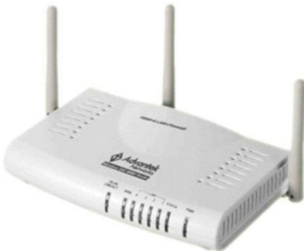
Figura 8.39 – Roteador + Ponto de acesso com tecnologia MIMO.
