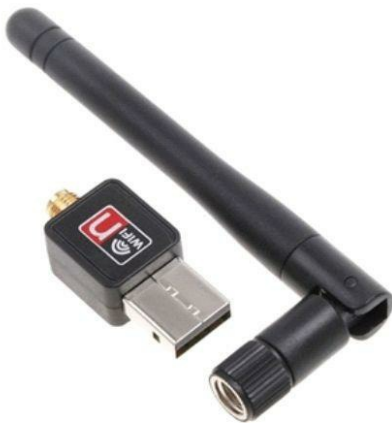
Figura 8.43 – Adaptador Wi-Fi USB – pode ser usado em laptops e desktops.
