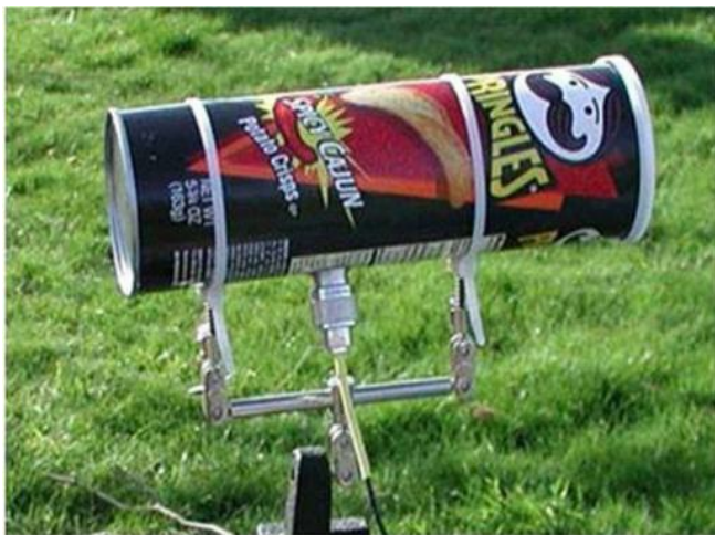
Figura 8.38 – Antena direcional feita com lata de batatas.
