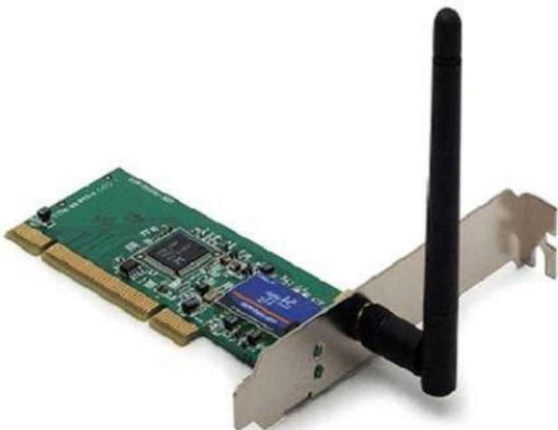
Figura 2.78 – Placa de rede Wi-Fi.
