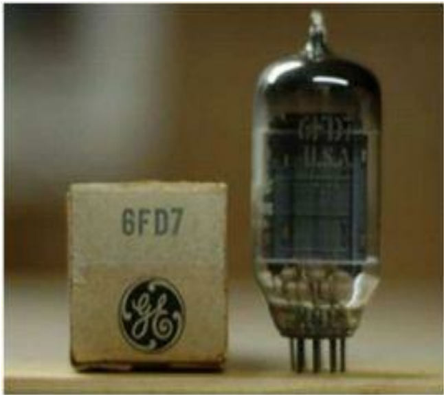
Figura 1.3 – Válvula elétrica, uma espécie de “lâmpada” inteligente.
