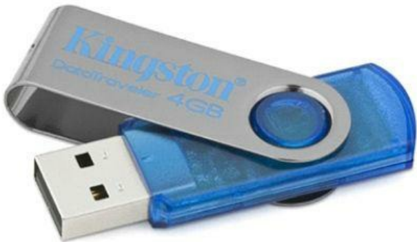
Figura 2.52 – Um pen drive (ou dispositivo de memória flash USB) da Kingston®.
