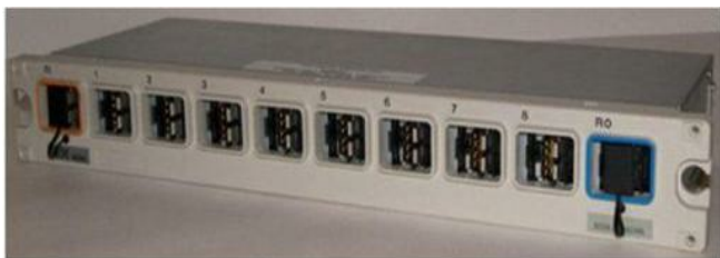
Figura 8.35 – Uma MAU (um concentrador Token Ring).
