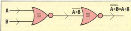
A saída para uma porta OU é  $A + B$ . Usando as regras da álgebra booleana, modificamos essa saída para uma forma  $\overline{E}$ :
