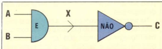
Nele, há duas entradas (A e B) e uma saída (C). Para auxiliar o estudante de lógica booleana a construir a tabela de validação para o circuito, a saída da primeira porta foi denominada X. Como existem duas entradas, há quatro combinações de entradas possíveis.
