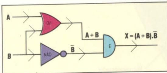
Ao desenhar um circuito lógico, convém que você comece pela saída e trabalhe para trás, em direção às entradas. Esse método sempre produz melhores esquemas de diagramas de circuitos.
