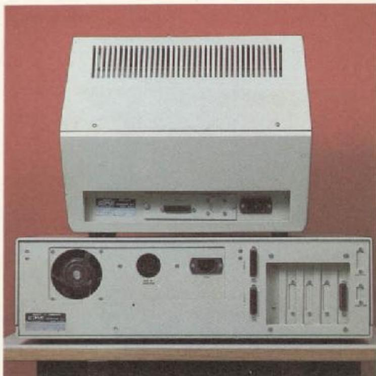
O Nexus 1600 dispõe de conexões para ligação de caneta ótica e para até duas avançadas de controle (joysticks) analógicas, com disparo.
