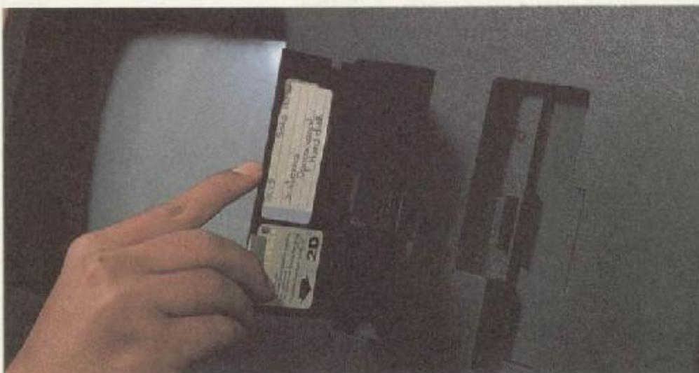
As unidades leitoras/gravadoras de discos flexíveis ficam em posição vertical, do lado direito do gabinete. A capacidade formatada é de 350 kbytes por disquete.
