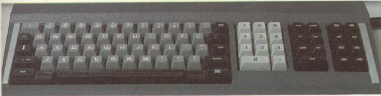
O teclado, eletromecânico, do tipo ASCII, tem três blocos: alfanumérico, numérico reduzido (com os dígitos de 0 a 9) e de funções. Do total de 88 teclas, 83 geram códigos; as outras definem o modo da operação.
