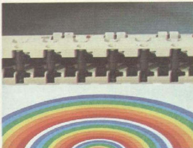
Canetas de impressão do plotter HP 7220. Suas oito canetas admitem seis larguras diferentes de linha. A caneta toca o papel suavemente, mediante um mecanismo amortecedor a ar.
