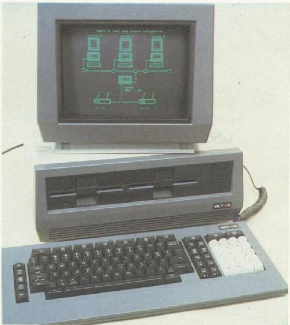
A versão CP/M 86 é empregada por computadores de 16 bits. Este computador incorpora o microprocessador 8086 e é gerenciado mediante essa variante de CP/M.
