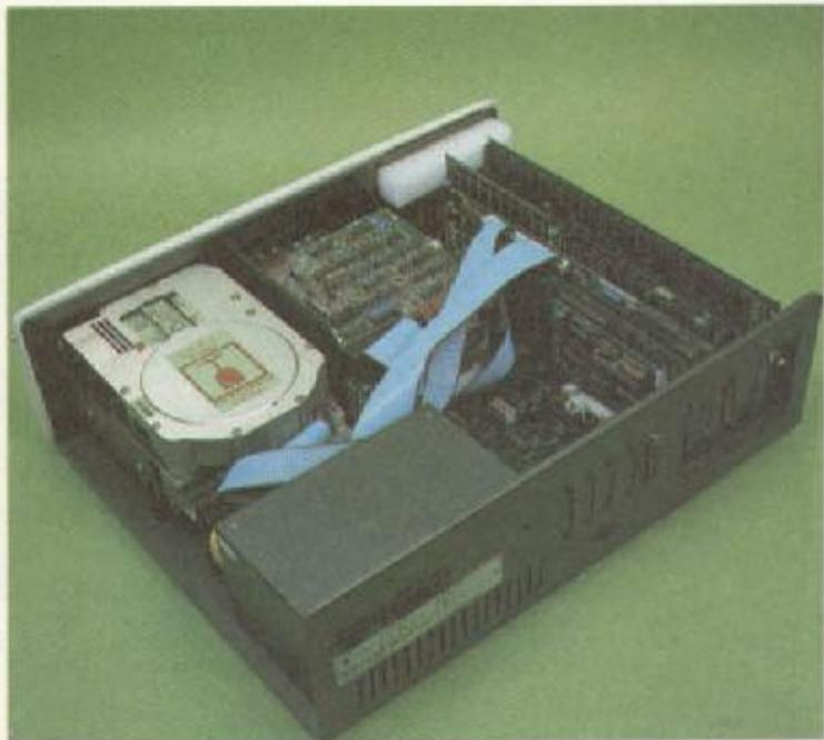
O equipamento pode ser expandido com diversas opções de periféricos e placas conectáveis. Além da impressora, pode ser utilizado um disco rígido (Winchester), que substitui uma das unidades de disquete.
