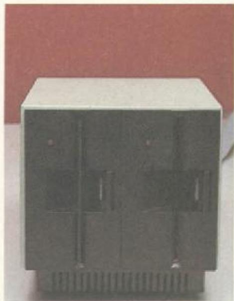
O SID 3000 utiliza discos flexíveis de 5 1/4" e o SID 3800, de 8". Ao contrário dos outros dois modelos, o SID 3900 baseia-se numa memória auxiliar de discos rígidos, de 10 Mbytes.
