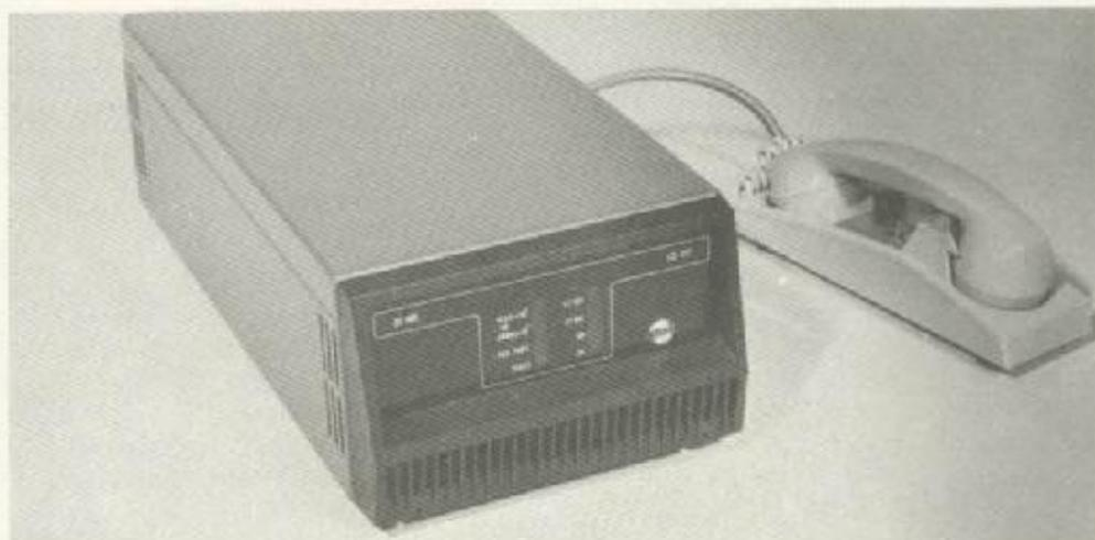
O modem síncrono analógico DS 4801, da Elebra, permite velocidades de 2400 e 4800 bps. No painel frontal, apresenta chaves de teste, circuito local digital e de áudio, teste de lâmpadas, seletor de velocidade e indicadores de taxa de erro, perda de portadora e teste.
