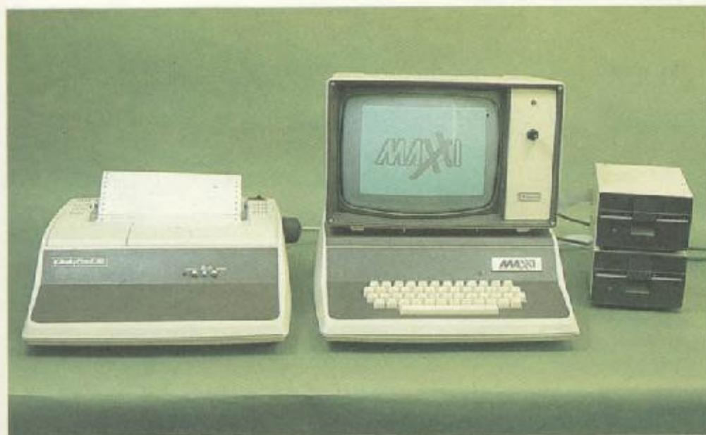
A memória auxiliar padrão do Maxxi fica por conta de um gravador cassete comum, com controle manual externo. Podem ser adicionadas, porém, até oito unidades de discos flexíveis de 5 1/4 polegadas ou então unidades de disco rígido de tecnologia Winchester.
