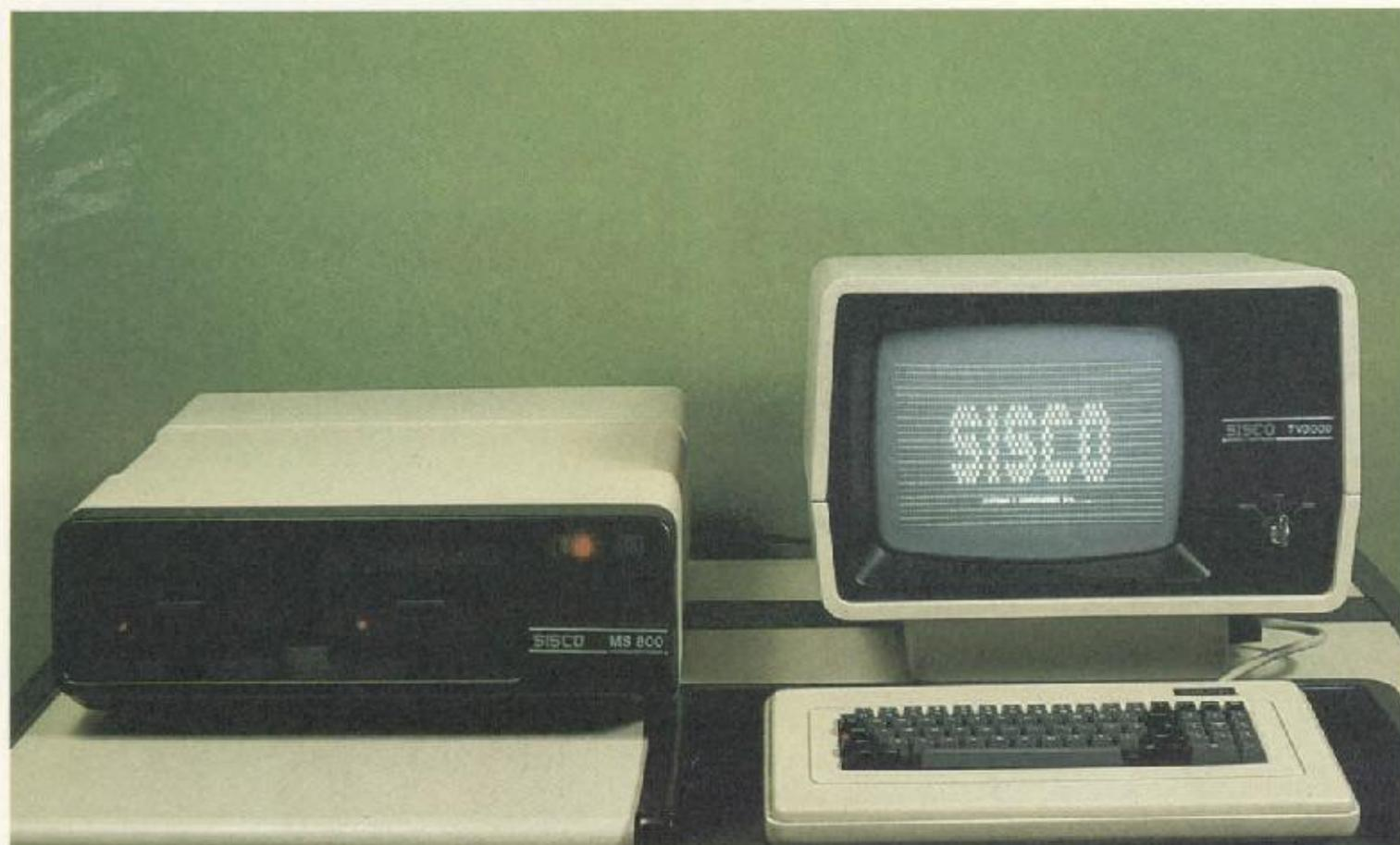
O MS 800 pode ser configurado para operar com qualquer impressora nacional, de interface paralela ou serial. Por meio de outra interface, ele pode emular um terminal IBM, Burroughs ou Honeywell-Bull.
