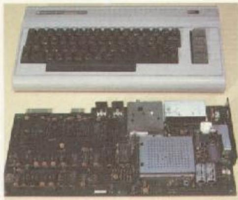
A unidade central de processamento é constituída pelo microprocessador 6510 da MOS Technology, inteiramente compatível com o tradicional 6502, do mesmo fabricante.
