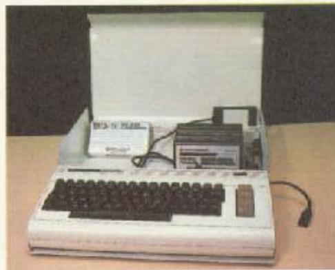
Para propiciar um aumento significativo da capacidade de memória, a Commodore criou um gabinete de ampliação, permitindo a conexão de vários módulos externos.
