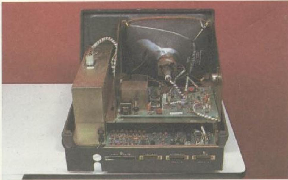
A UCP dos microcomputadores da série SID 3000 baseia-se no microprocessador Intel 8085A, de 8 bits, com relógio de 2,76 MHz. A memória principal tem uma área de RAM de 64 kbytes (não expansível) e uma de ROM de 16 kbytes.
