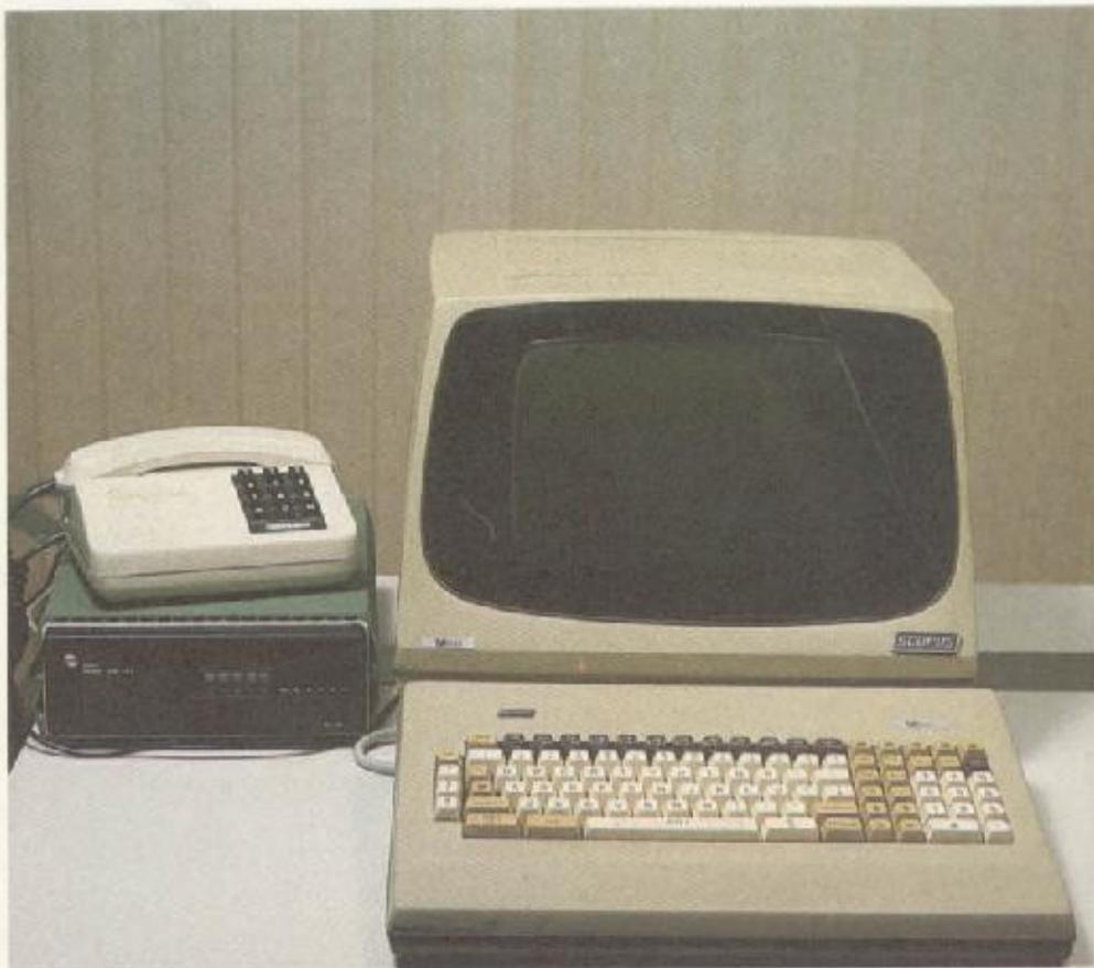
Terminal de central telefônica digital, por programa armazenado (CPA), constituído de microcomputador e modem telefônico. O modem transforma a informação digital binária do computador em sinais dentro do espectro sonoro audível pelos seres humanos.
