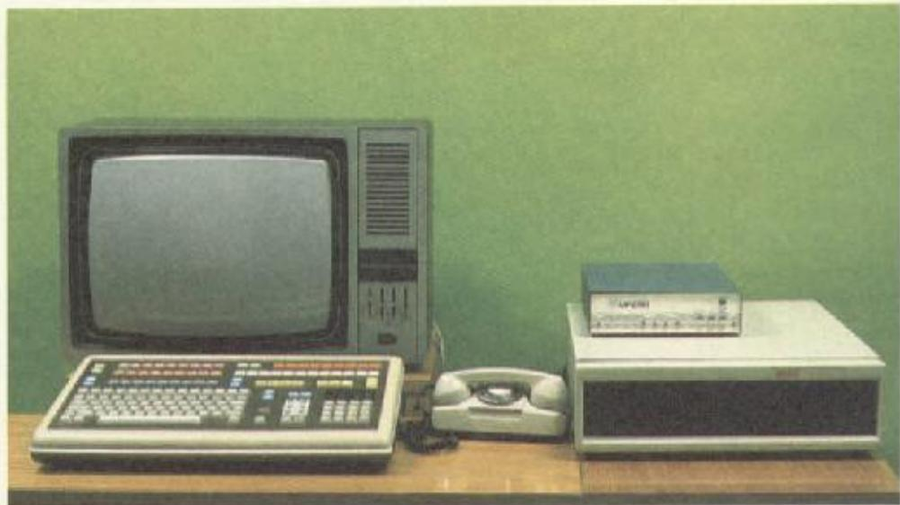
O acesso das informações armazenadas em memória de computador, no sistema Videotexto, é feito graças à conexão de um aparelho telefônico a um receptor de televisão doméstico. Para isso, usa-se um dispositivo dotado de teclado alfanumérico, por onde o usuário dá entrada a seus pedidos de informações.
