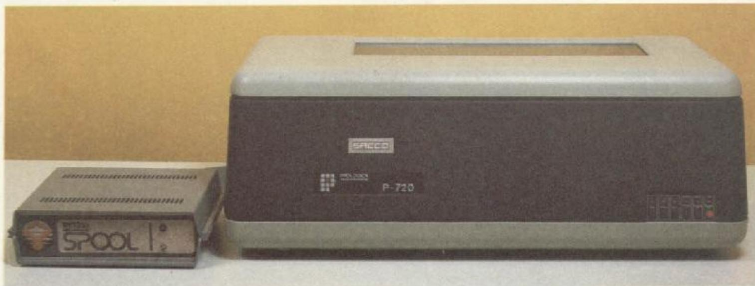
Com a interface de spooling BYTESSPOOL pode-se usar transmissão serial ou paralela; a vantagem da transmissão em paralelo é que se obtém maior velocidade, já que os 8 bits de um caractere são transmitidos ao mesmo tempo, o que não acontece com a transmissão serial, que se processa 1 bit por vez.
