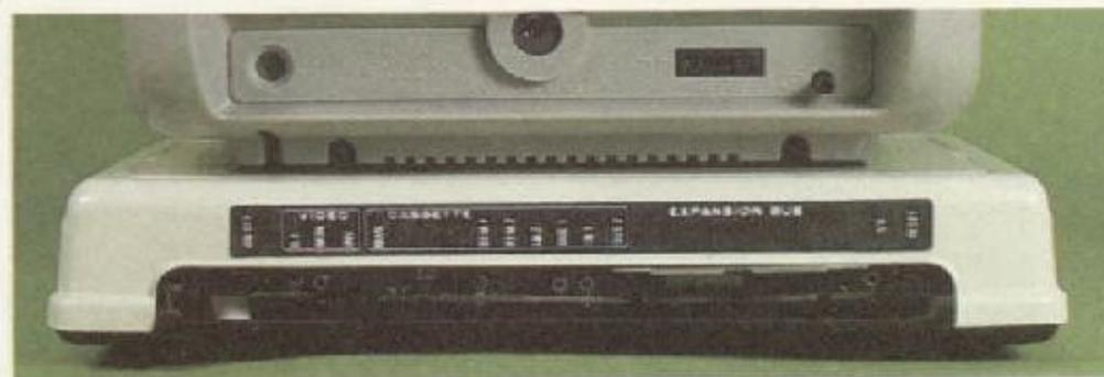
Na painel traseira da console encontram-se os conectores para os variados periféricos padrões, além de botões RESET, liga/desliga, controle manual do gravador e do vídeo. O barramento do sistema é disponível para expansões futuras.
