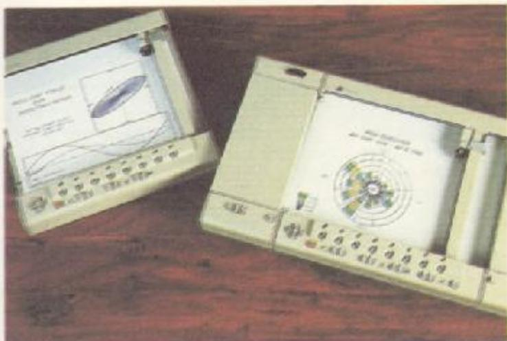
Os plotters HP de mesa horizontal podem realizar até 270 desenhos sem necessidade de assistência. Mediante um visor, podem atuar também como digitalizadores.
