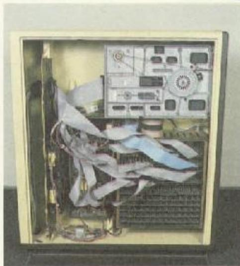
A unidade central do sistema é montada em gabinete vertical de perfil estreito, que contém a UCP, placas de memória RAM, interfaces e controladores de E/S.
