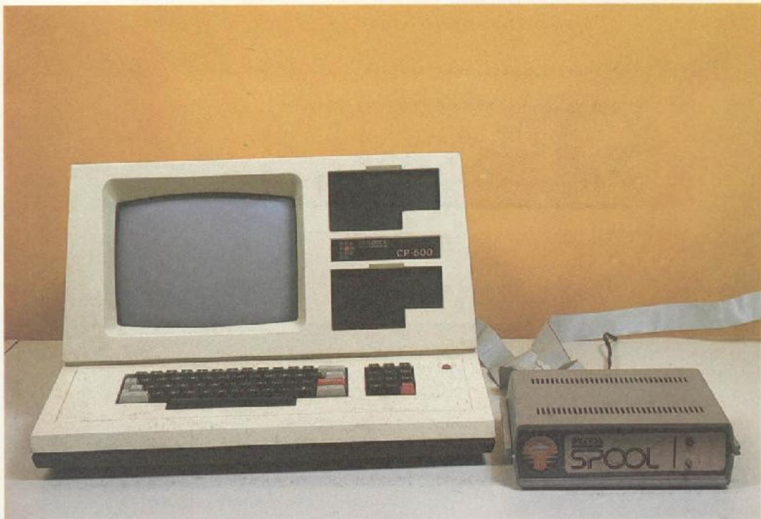
Memória auxiliar para impressora BYTESSPOOL, produzida pela Byless/Claritron, conectada a um computador Protológica CP 500. Na foto vêem-se os cabos que fazem as interligações. Para cada tipo de equipamento são fornecidos cabos específicos, conforme indicação dos fabricantes.
