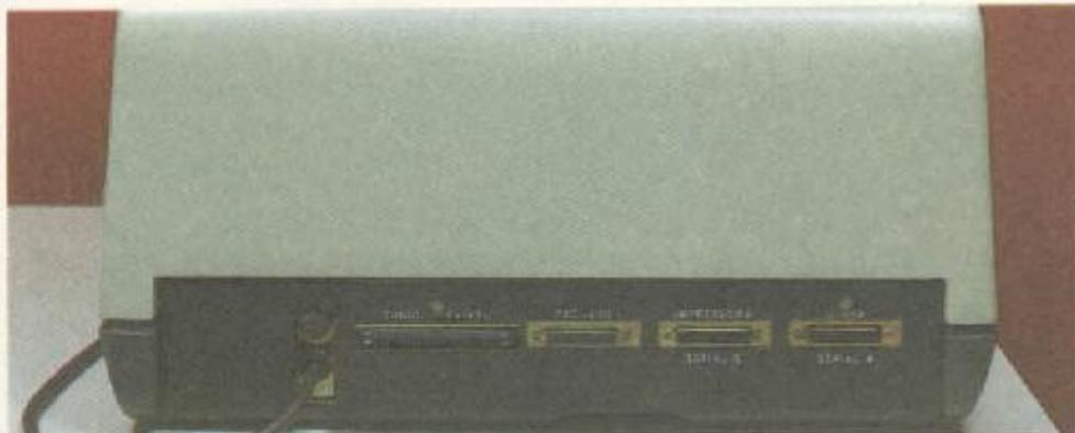
*A interface de comunicação pode ser serial RS-232C ou diferencial no SID 3800 e no SID 3900, mas no SID 3000 só pode ser serial. Essas interfaces permitem a ligação de um SID 3000 a outro SID 3000 ou ainda a outros equipamentos, à distância.*
