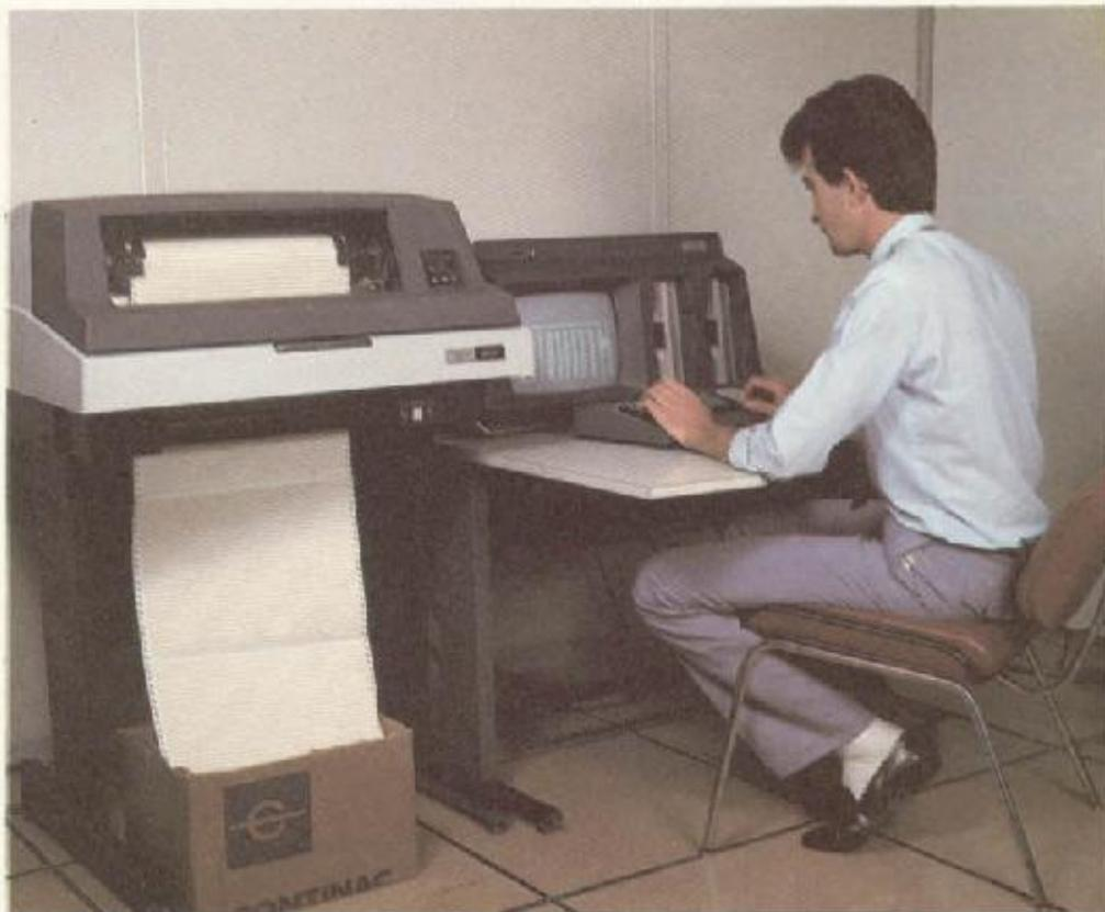
A configuração padrão do Cobra 305 engloba UCP, vídeo, teclado e duas unidades de acionamento de disquetes de 8". A configuração máxima permite grande ampliação da memória auxiliar e oferece amplas opções de conexão de periféricos, especialmente impressoras.
