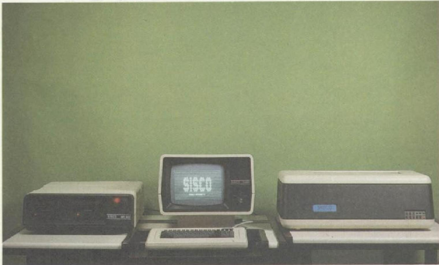
O microcomputador MS 800 é totalmente modular e utiliza um terminal inteligente como console do sistema. Além do vídeo e do teclado, é composto pelo gabinete da unidade central e por uma impressora matricial.
