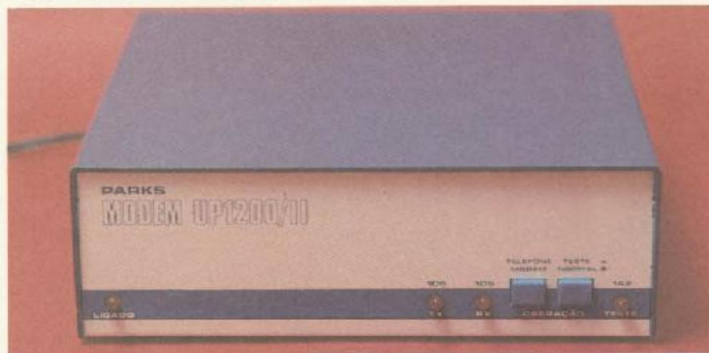
Além dos modelos descritos no artigo, a Parks produz o modem UP 1200/10, com velocidade de transmissão (assíncrona analógica) de até 1200 bps, em modo duplex a quatro fios e semiduplex a dois. A modulação de seu transmissor é em FSK; as frequências são marca 1300 Hz e espaço 2100 Hz.
