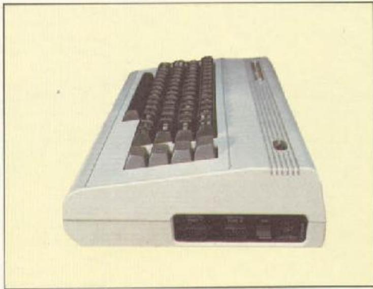
Na lateral direita da unidade central encontram-se, além da conexão com a rede e o interruptor de potência, os conectores para joysticks e caneta ótica.
