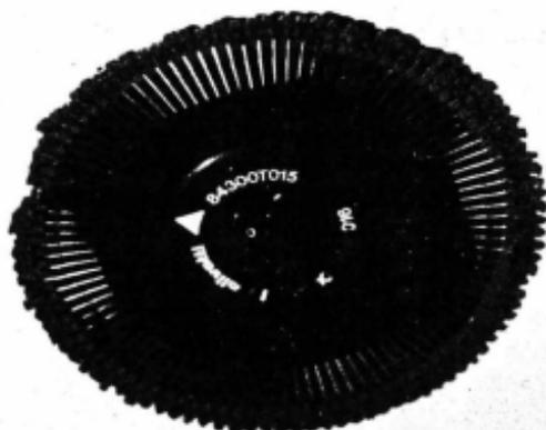
Fig. 1. Elemento de impressão das impressoras de margarida: se observam os braços onde estão situados os caracteres.
