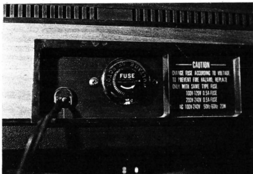
Fig. 5. Fonte de alimentação com fusível e seletor de tensão.
