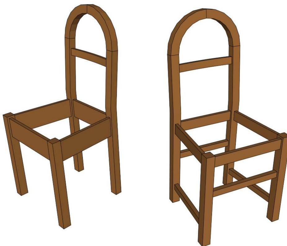
**FIG 18** – Comparação entre cadeiras com travamento inferior e sem travamento.
