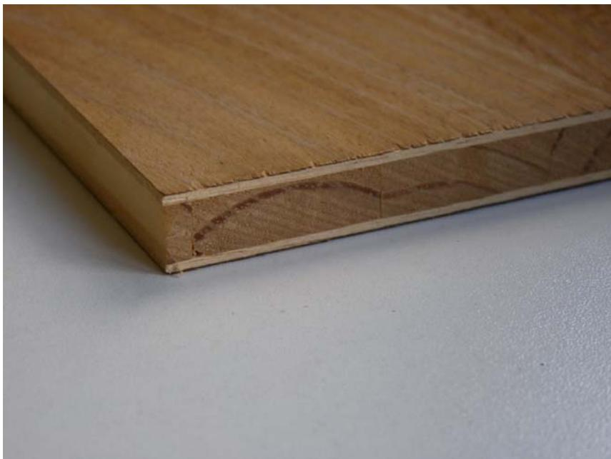
**FIG 59** – Painel de compensado sarrafeado
