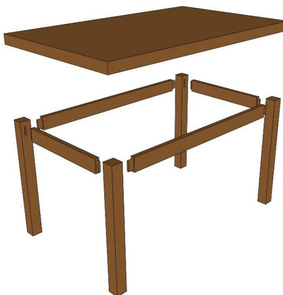
**FIG 29** – Estrutura esquemática de mesa.
