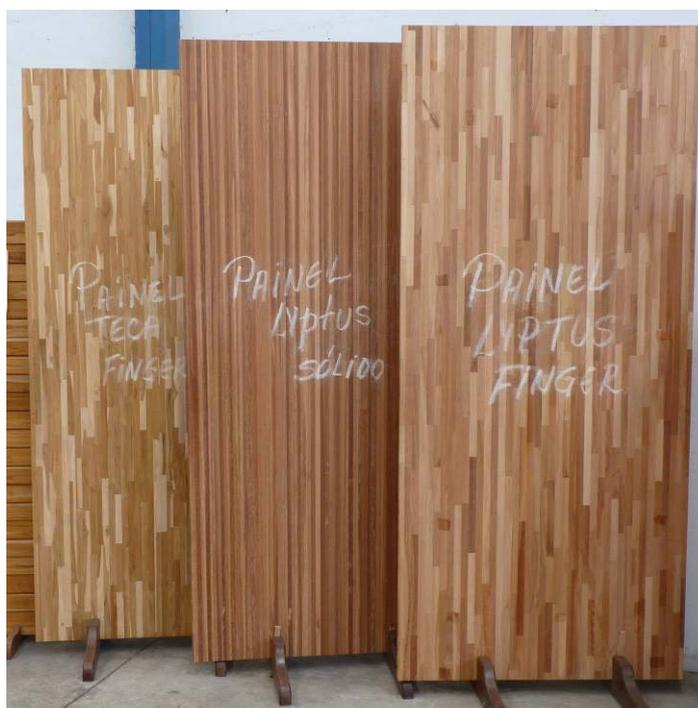
**FIG 62** – Painéis EGP construídos a partir de Teca e Eucalipto. Nos dois últimos à direita, notar a diferença entre o painel “Lyptus sólido”, confeccionado a partir de sarrafos contínuos, e o “Lyptus finger”, produzido com sarrafos descontínuos em esquema de mata-junta.
