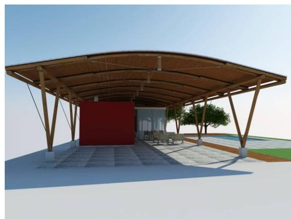
**FIG 3b** – Projeto de área de lazer residencial a ser construída com eucalipto retificado.
