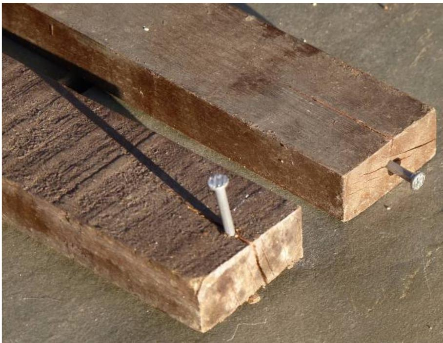
**FIG 42** – Ilustração da tendência de ruptura dos topos das madeiras quando nelas se inserem pregos ou parafusos.
