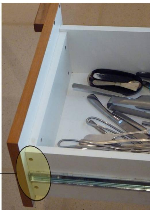
**FIG 74** – O quadro da gaveta é construído a partir da fixação de dois parafusos em cada quina e os topos de MDF laminado recebem fitas de topo.
