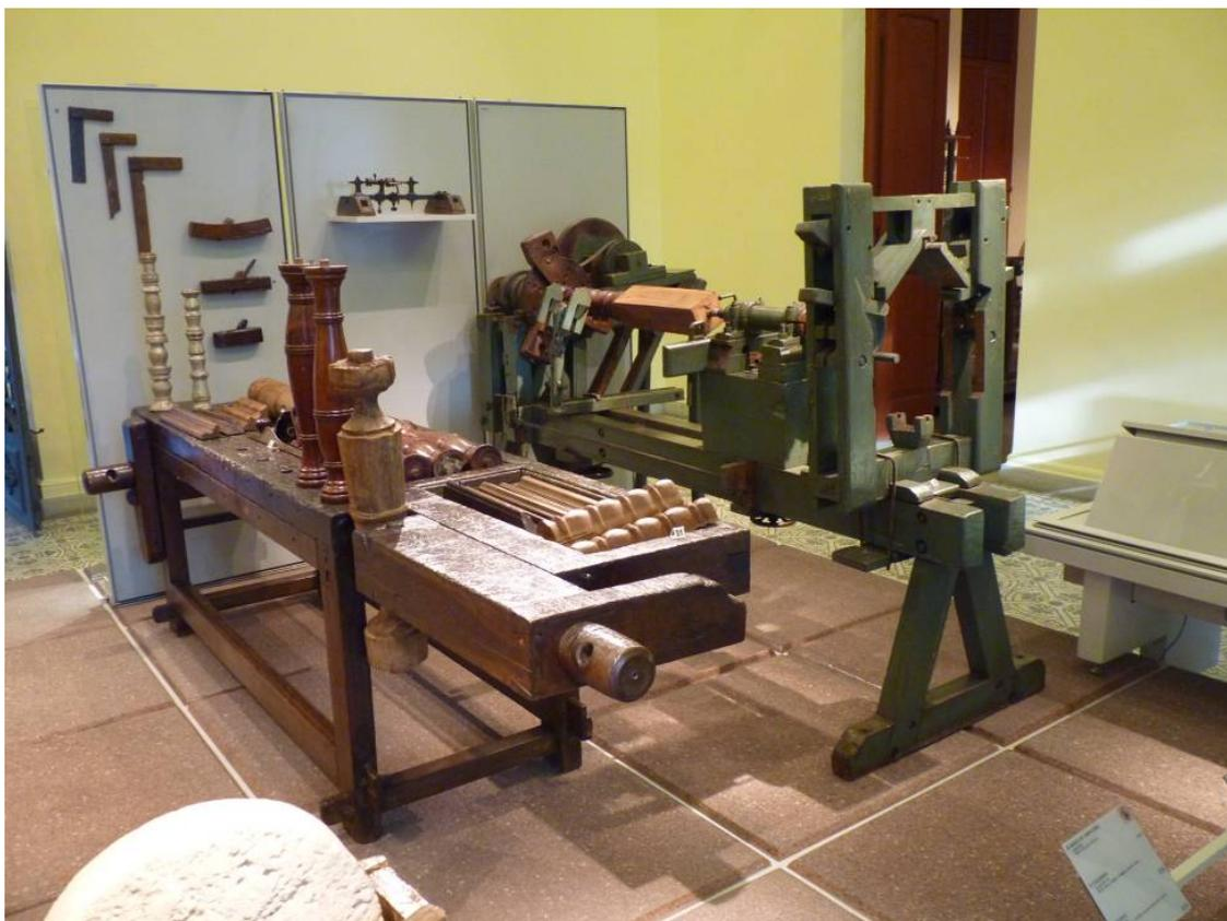
**FIG 34b** – Torno (verde) construído em madeira para acionamento hidráulico. Museu de Artes e Ofícios de Belo Horizonte.
