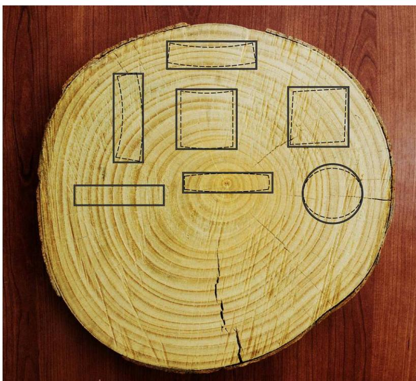
**FIG 23** – Alterações dimensionais por contração e dilatação.
