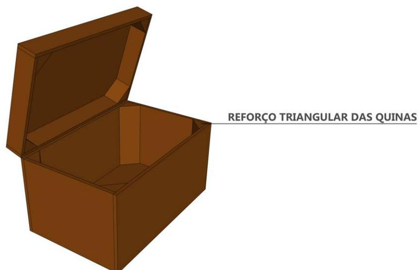
**FIG 43** – Caixa com reforços triangulares nas quinas.
